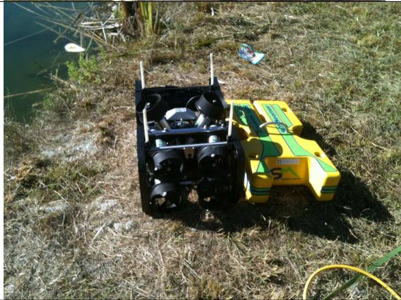
Robot submarino. Con capacidad de 300 metros de profundidad.
